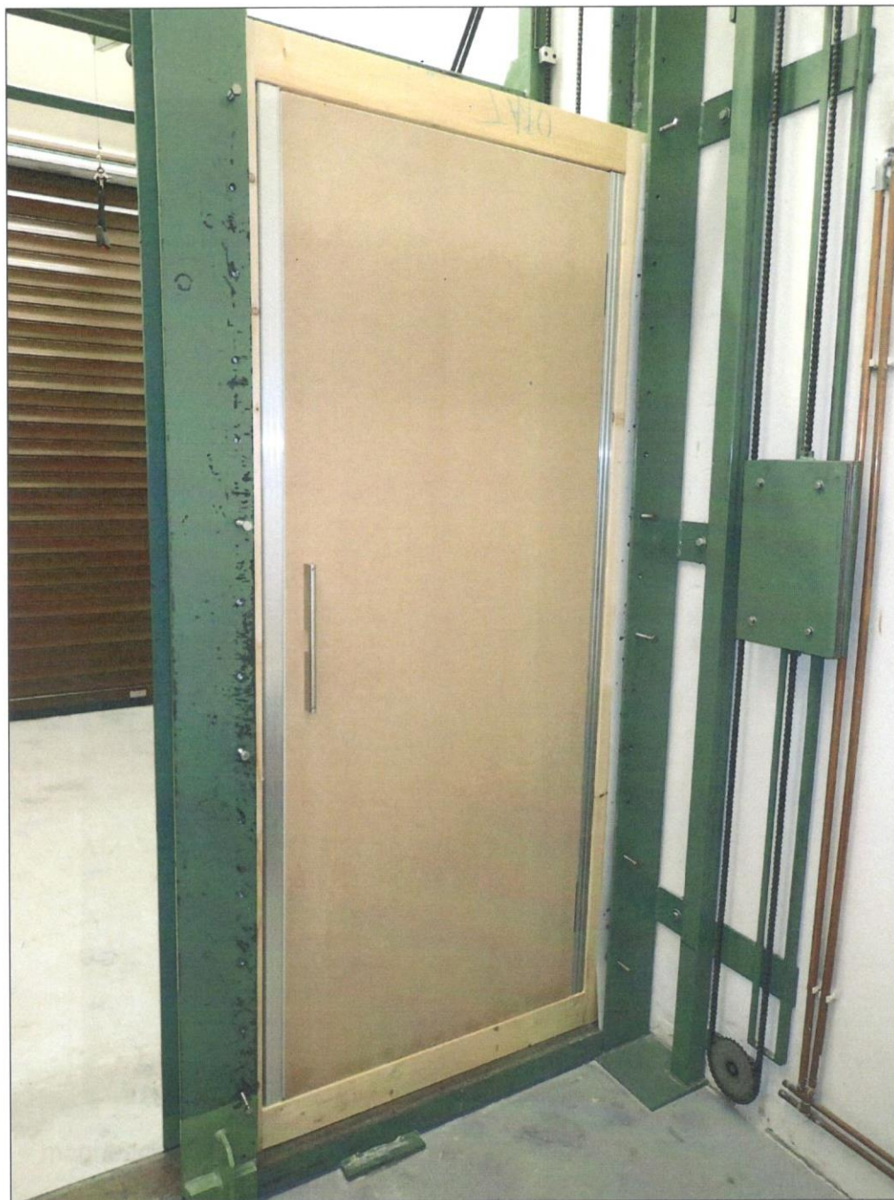
obr. 2 – zkušební vzorek instalovaný ve zkušebním rámu – strana napadení (vnější strana)
