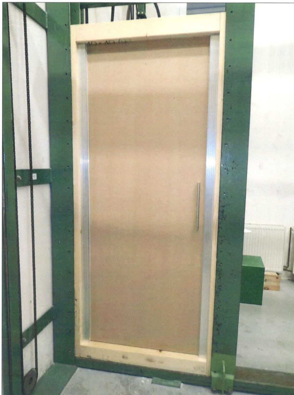
obr. 1 – zkušební vzorek instalovaný ve zkušebním rámu – chráněná (vnitřní) strana
